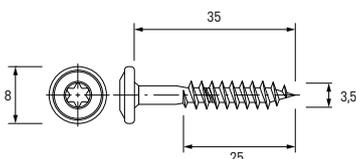
Шурупы для установки на деревянной обрешетке / ағаш құрылымын орнату үшін арналған бұрандалар / шурупы для сборки на дравляной канструкції / саморізи для монтажу на дерев'яній конструкції / şuruburi pentru montajul pe structură din lemn / винтовe за монтаж върху дървена конструкция / faszervezetre történő szereléshez használt csavarok
