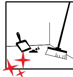
Основание должно быть гладким и без изъянов а его допустимая неровность составляет макс. 2 мм на отрезке 1 метра.
