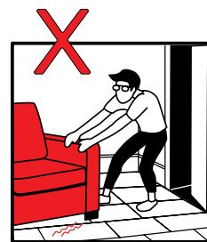
По полу можно ходить сразу же после укладки. Места интенсивного пользования или установки тяжелой мебели требуют под克莱ивания пола или применения защитных матов. Не применять мебели с резиновыми подкладками под ножки, потому что они могут оставлять следы на полу. Следует помнить, что размещение очень тяжелых предметов на ламинате/плитке может привести к их стойкой деформации.
