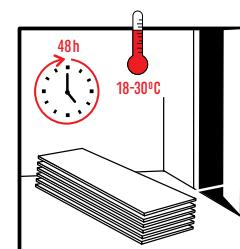
При монтаже температура в помещении должна составлять 18-30°C. Если температура выходит за эти пределы, клеем следует покрыть все помещение.
